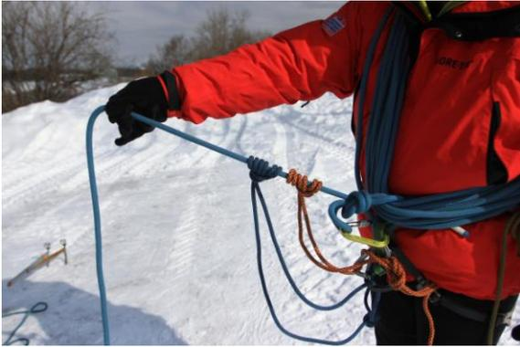
**10 Правильная регулировка аварийной системы. Схватывающие узлы не нагружены.**
