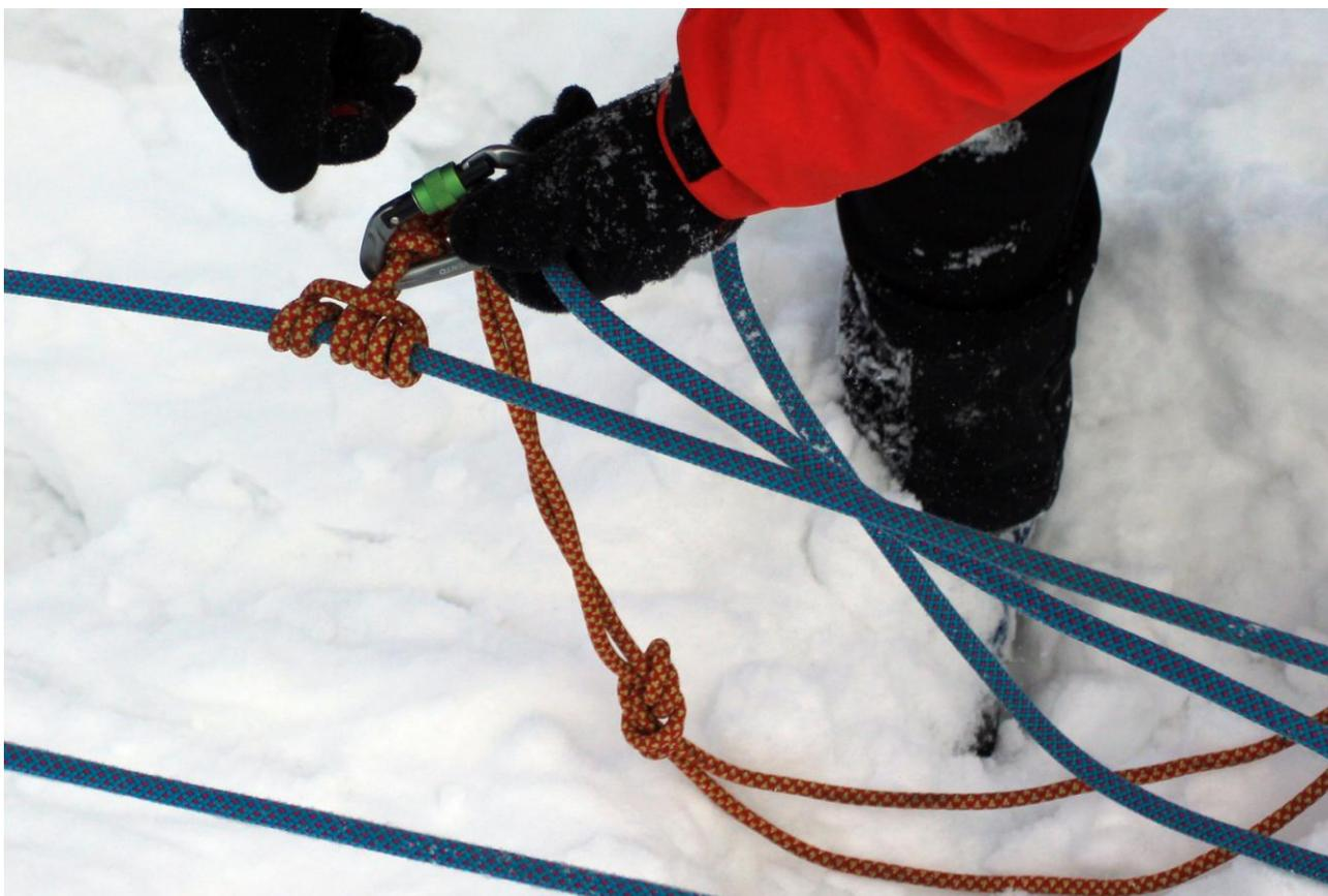
16 Использование схватывающего узла от аварийной системы для организации полиспаста.
