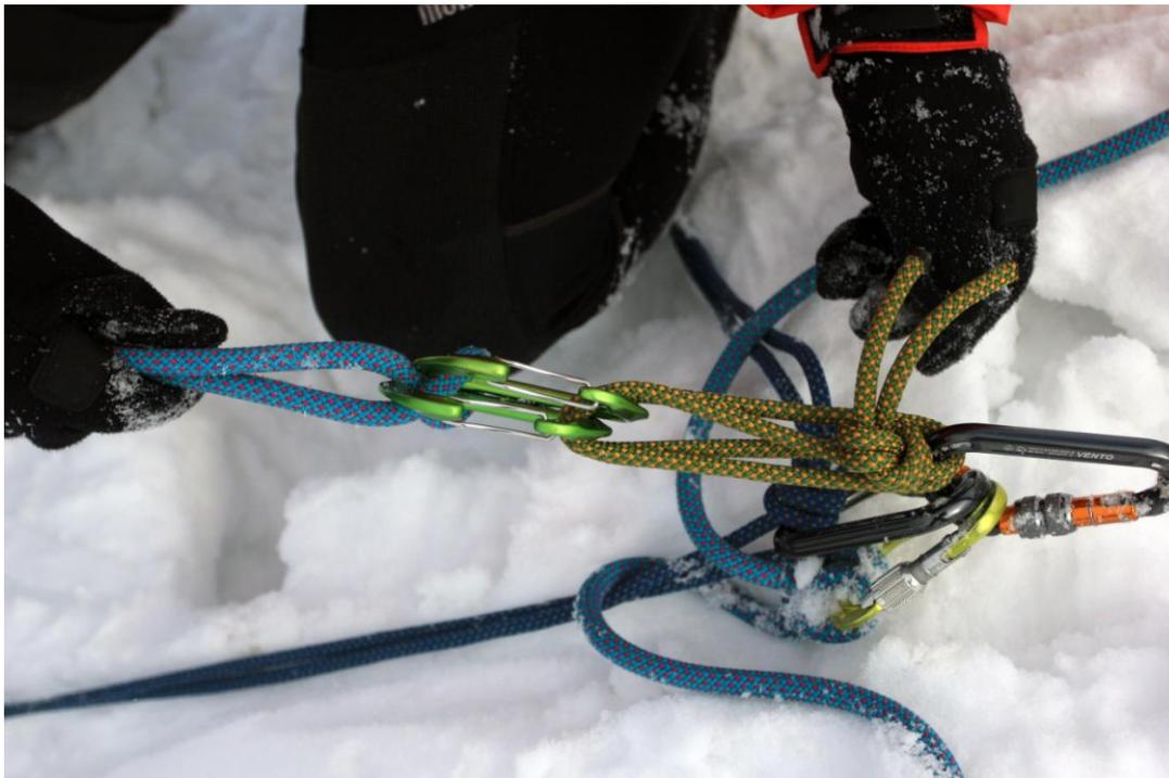
Далее спомощью схватывающего узла или механического зажима организуется классический Z-образный полиспаст 3:1, возможна организация полиспаста 5:1 или 7:1.
